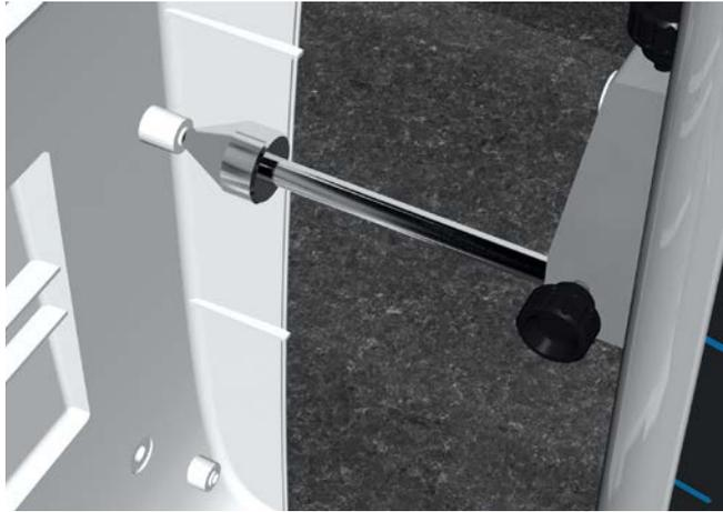
Messung des Achsabstands an einem elektronischen Plastikgehäuse
