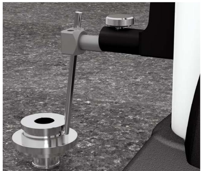
Bestimmung der Tiefe einer Nut auf einem Bestandteil eines Endoskopiemesegeräts
